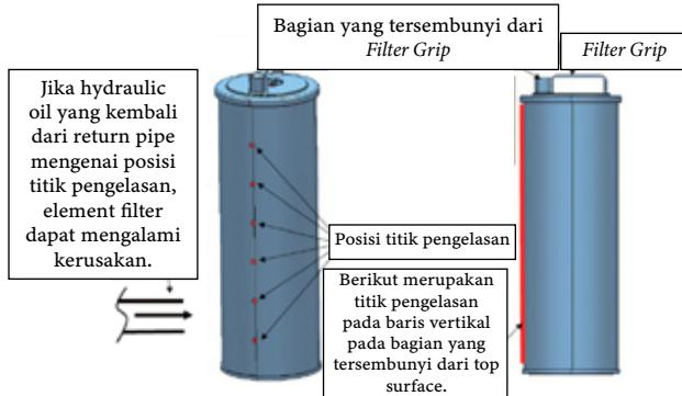
Petunjuk pemasangan *Hydraulic Return Filter* pada tiap model unit (Hal berikut ini juga berlaku untuk model yang dilengkapi dengan *High Performance Hydraulic Return Filter*).
