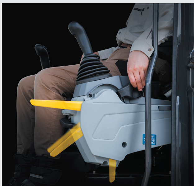
Tuas penghenti pilot dengan desain baru Tuas penghenti pilot yang baru didesain untuk mempermudah penguncian dan pembukaan kunci dengan dioperasikan oleh gerak pergelangan tangan.
