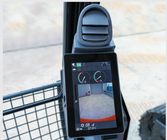
Monitor berwarna 8 inci dengan pantulan rendah dan layar yang 42% lebih besar dibandingkan layar pada seri ZX-5G. Lebih mudah dilihat dan dinavigasi. Tersedia catu daya USB dan Bluetooth® opsional.
